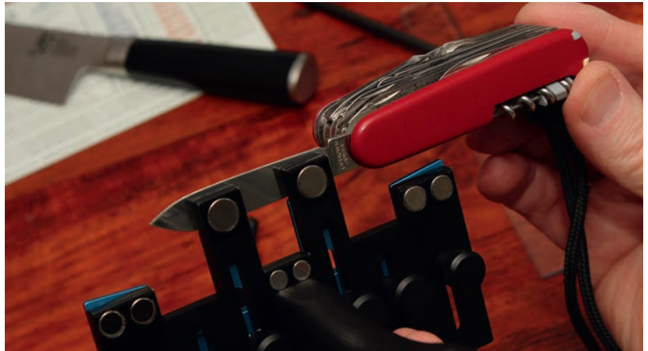
Anziehend: Die Klingen werden über starke Magnete in Position gehalten (Blick von unten).
