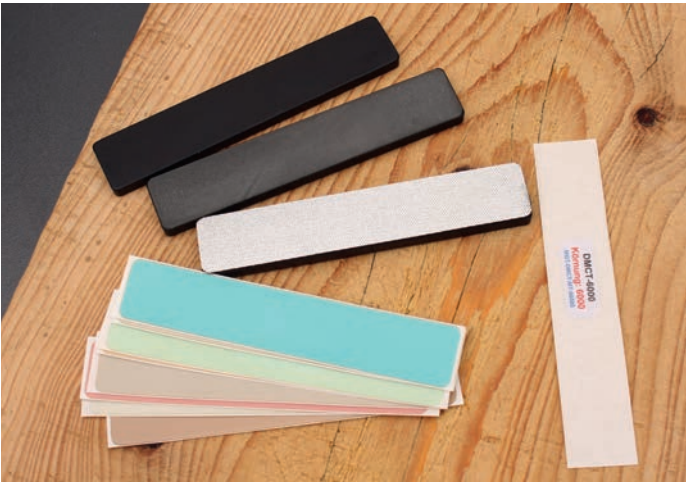
Hauchdünn: Als Schärffmedium dienen vor allem selbstklebende Folien, die mit Aluminiumoxid oder Diamanten besetzt sind.
