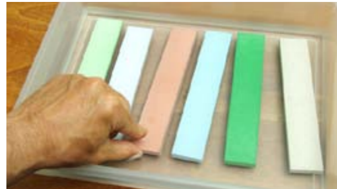
Kurze Vorbereitung: Vor der Arbeit muss man die Wassersteine für wenige Minuten wässern. Die Schale wird mitgeliefert.
