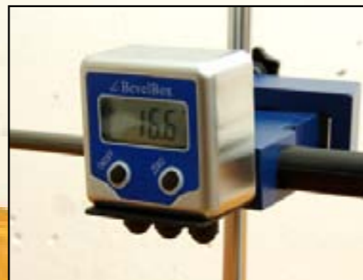
Super-exakt: Der Winkel zwischen Auflagefläche und Schleifstein wird auf 0,1 Grad genau digital angezeigt.
