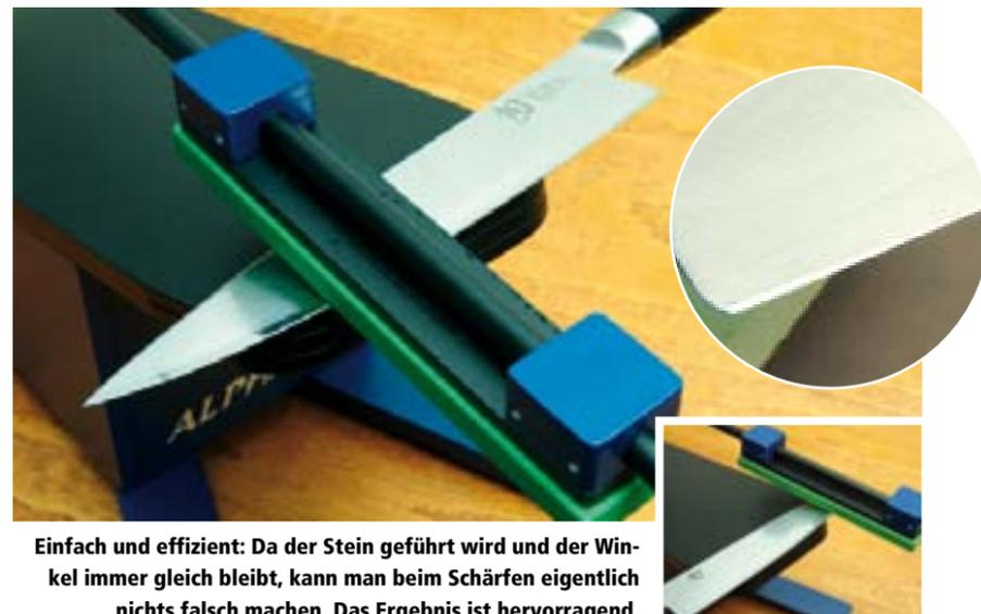
**Einfach und effizient:** Da der Stein geführt wird und der Winkel immer gleich bleibt, kann man beim Schärfen eigentlich nichts falsch machen. Das Ergebnis ist hervorragend.
