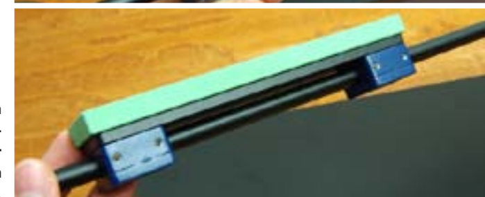
Super-einfach: Die japanischen Wassersteine sind auf Alu-Platten montiert und werden per Magnet-Schnellhalterung am Gerät befestigt.
