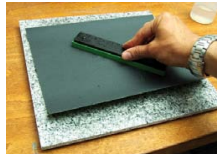
Hin und wieder nötig: Wenn die Wassersteine sich abnutzen und uneben werden, kann man sie auf der mitgelieferten Marmorplatte wieder abrichten und plan machen.
